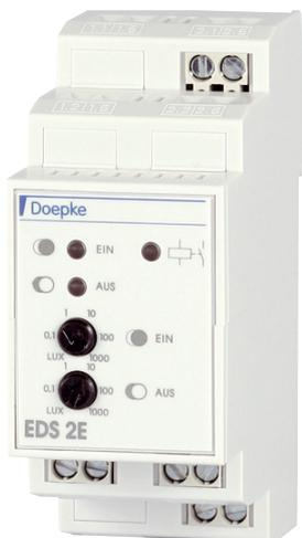
Die Wirtschaftsbetriebe der Stadt Norden GmbH schalten seit dem 01.06.2010 die gesamte Straßenbeleuchtung der Stadt mit Hilfe des Dämmerungsschalters EDS 2E. Der Schaltbefehl wird vom EDS 2E an ein Rundsteuersendegerät weitergegeben, das dann die Rundsteuerempfangsgeräte im Innen- und Außengebiet der Stadt Norden anspricht.
